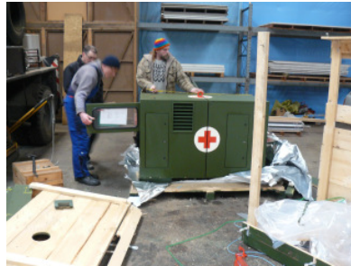
Das BW-Aggregat mit 2 Zyl. Hatz-Motor
